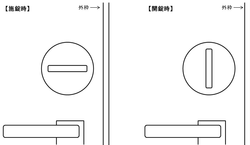
貼付ボスの両面テープカバーを剥がし、以下のようにサムターンに貼り付けてください。(事前にホコリなどを取り除いて下さい)
