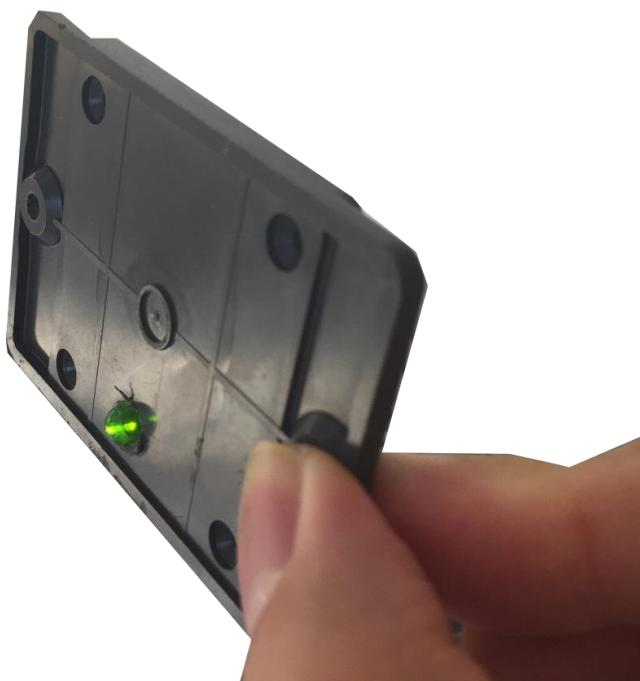
LED が点灯することを確認して下さい。(LED は開錠時のみ点灯します。)
